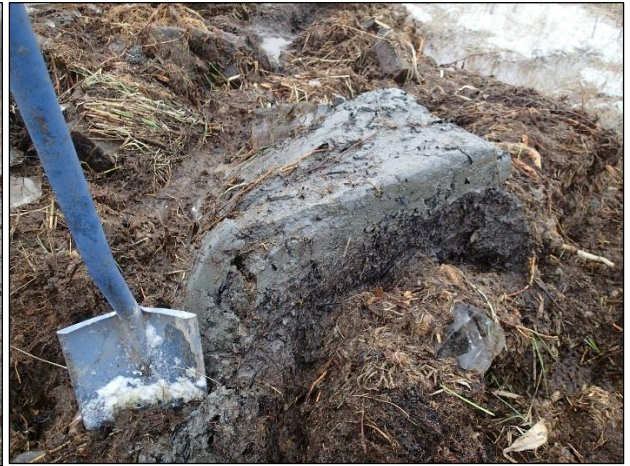
Vasemmalla: Ruoppaus käynnissä. Vesi estää näkyvyyden kaivantoon, joten havainnot on tehtävä läjityskasasta, joka näkyy kuvassa vasemmalla. Oikealla: Ylösalaisin läjityskasaan tippunut kauhallinen, josta näkee, että eloperäiset kerrostumat alkavat heti saven yläpuolelta, ilman kuivan maan kerrostumia.
